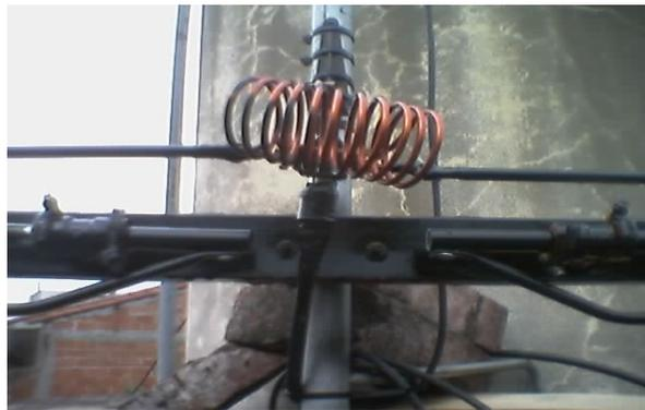
de cobre esmaltado de 4 mm de diámetro, sobre un diámetro de 5 cm. devanando en él 7,5 vueltas con un espaciado entre espiras de 1,5 cm. La bobina terminada se conecta entre el vivo y la masa del centro de dipolo, es decir, cortocircuitando el dipolo. Respetando las medidas, tal como las expliqué arriba, la antena sale funcionando sin necesidad de calibración. Es fundamental poner la antena lo más alta posible para mejor rendimiento.
